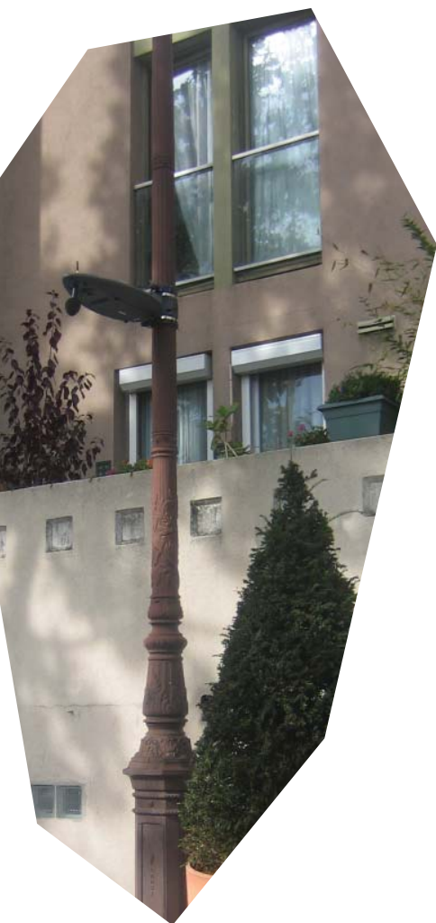
Station de mesure implantée à Puteaux pour surveiller le bruit routier, ferroviaire et de chantier
